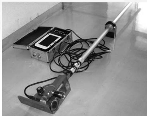
写真3 管渠内撮影用マンホールカメラ
