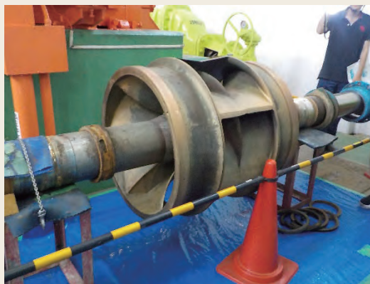
▲ポンプから取り外した横軸とインペラー
