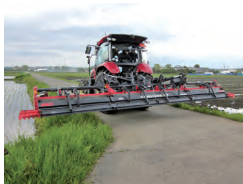
▲RTK-GNSS自動運転トラクター背面
