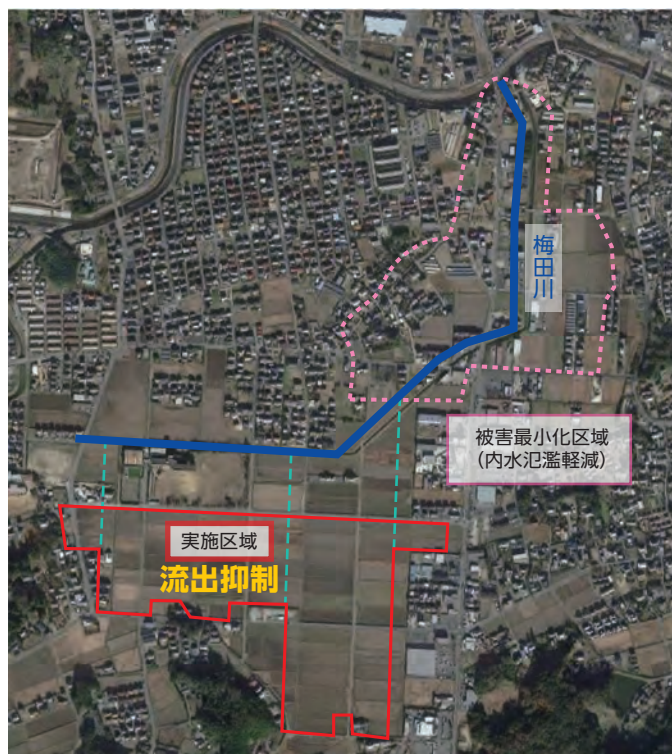
図5 「田んぼダム」下流の浸水被害を最小化
